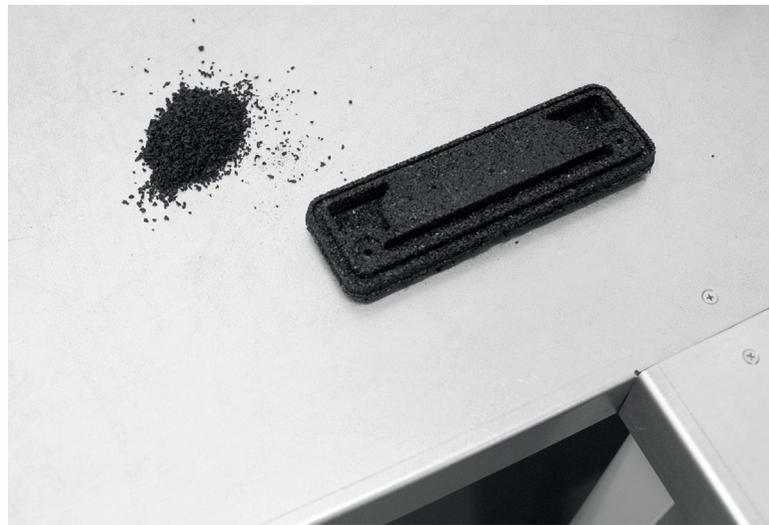
Fig.70 Gummigranulat und gepresste Gummischale
